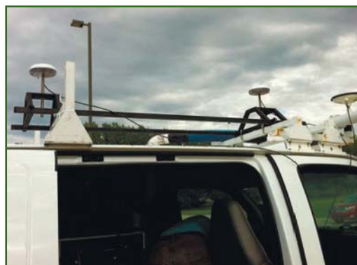
Рис. 1 Общий вид антенн ГНСС, установленных на крыше автомобиля
